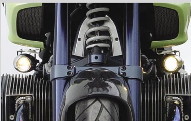
Illuminator: faro a proiezione ellipsoid per la R
